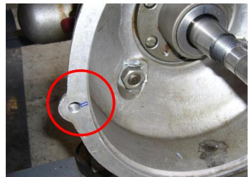
4. Rotor so aufsetzen, dass die Markierung am Gehäuse mit der Markierung Rotor fluchtet. Unbedingt darauf achten, dass sich die Kurbelwelle nicht verdreht! Position des Rotors auf der Kurbelwelle markieren. Rotor wieder abnehmen.
